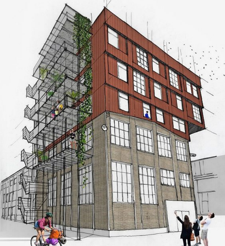
Besteht zu fast zwei Dritteln aus alten Bauteilen: Die aufgestockte Halle 118 auf dem Lagerplatz. Visualisierung: PD
